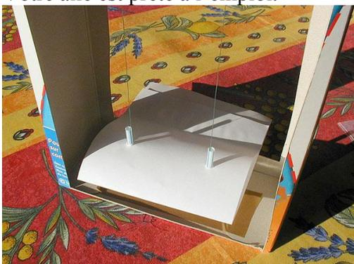
Placer l'aile de manière à avoir le bord arrondi (bord d'attaque) au dessus.
